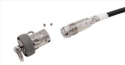
Trä på terminalen på lina och vik linans kärna över den tredelade konan. Fixera konan i terminalen.
