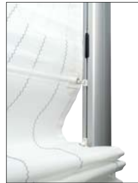
3) Travarna förbinder alltid seglet med masten, vilket underlättar vid sättning och revning.
