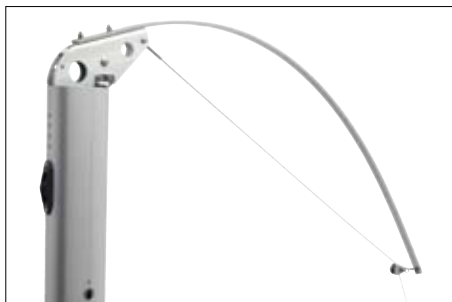
Seglets akterlik skonas genom att lattan lyfter akterstaget vid gipp och stagvårdning.
