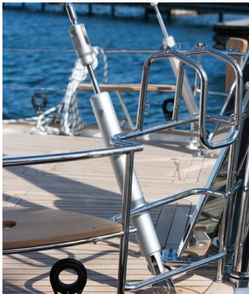
Tensionner de patares hydraulique (HT), commandé depuis un panneau de commande
