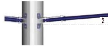
Pour une robustesse optimale, les platines de barre de flèche ont un dièdre angulé de 6°.
