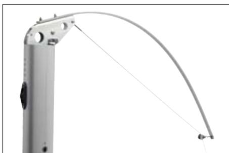
La latte de pataras soulève le pataras pour éviter d'endommager la chute de grand-voile à l'empannage ou au virement de bord.
