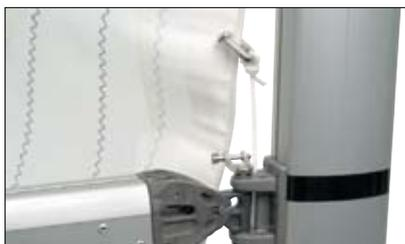
1) Fixez l'endrailleuse à la ferrure de bôme.
