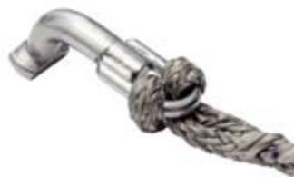
Lors du remplacement d'un câble traditionnel par une bastaque légère en cordage, en HMPE (Dyneema) par exemple, conservez l'ancrage existant et utilisez une articulation Té/Œil.
