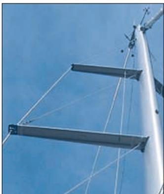
Barres de flèche type T Seldén pour mâts section C et F.
