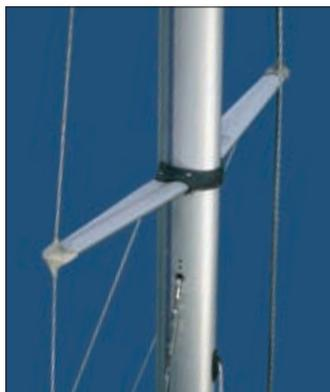
Barres de flèche type P Seldén pour mâts section D, section E et section R.
