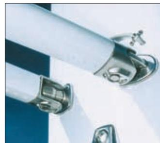
La grande largeur des embases de barres de flèche en V est une autre manière d'accroître la résistance sur les gréements de grande taille. La fixation de ces embases traverse le mât.
