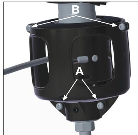
3. Introduzca aproximadamente 24 vueltas del cabo del enrollador en el tambor girando la horquilla articulada/toggle en el sentido de las agujas del reloj si el cabo debe salir por el lado de babor del tambor o en el sentido contrario al de las agujas del reloj si debe salir por estribor. El ajuste preciso del tambor se describe en el capítulo 5.3.
