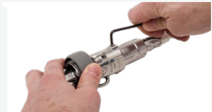
Monte el tambor/giratorio de driza y apriete el tornillo de bloqueo.
