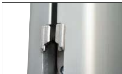
2) Alimente el cabo de grátil dentro de la entrada de vela.
