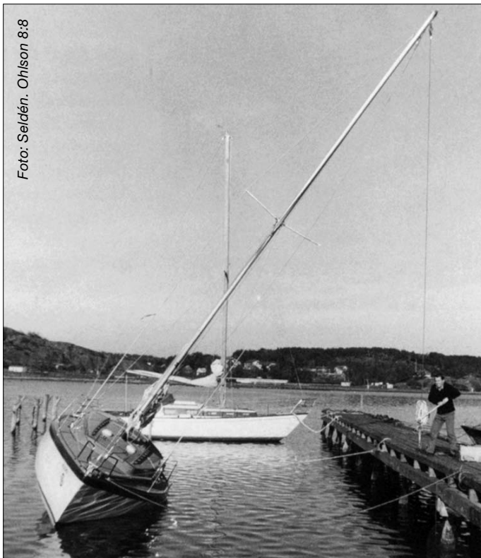
Prueba de escora en 1971. El par de adrizamiento del barco se mide a 30° de escora.
