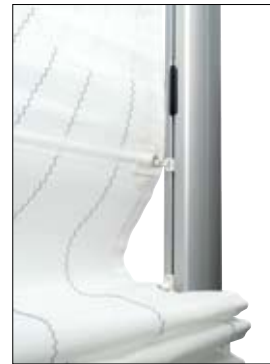
3) Los patines siempre unen la vela al mástil, simplificando el izado y la toma de rizo.
