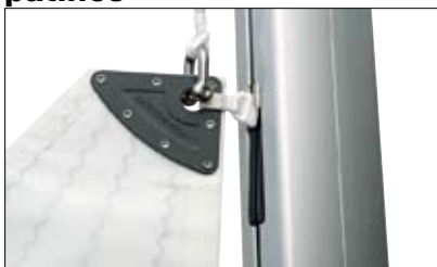
1) Alimente todos los patines dentro de la entrada de vela.
