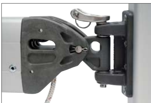
El pasador de aleta se aloja en un hueco impidiendo los daños al material de la vela.
