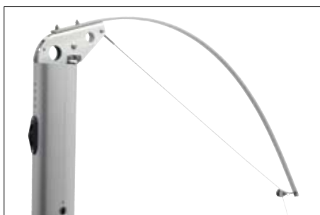
El separador de backstay iza el estay para impedir daños sobre la baluma de la vela cuando traslucha o vira por avante.
