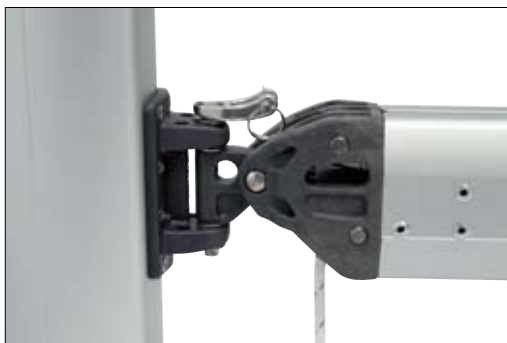
Cabeza en forma de D del bulón.
