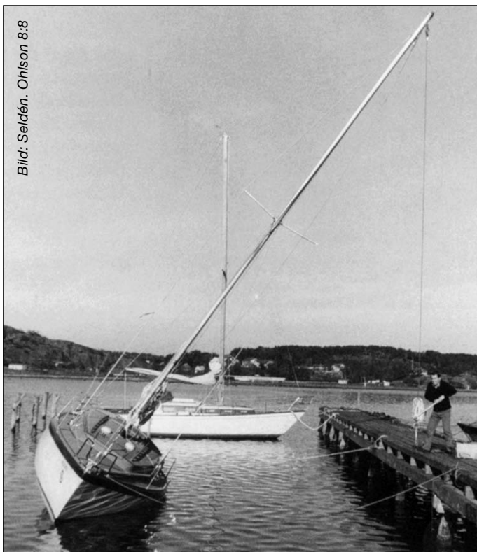
Krängningstest 1971. Båtens rätande moment mäts vid 30° krängning.
