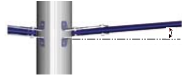
Spridarfästet är vinklat 6° uppåt för att ge bästa möjliga stagning av masten.
