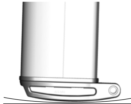
Konvex skoning. Aldrig punktbelastning på maströret.
