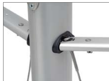
Undervant monterade i genomgående spridarfäste. C106-C139, CC105-CC138
