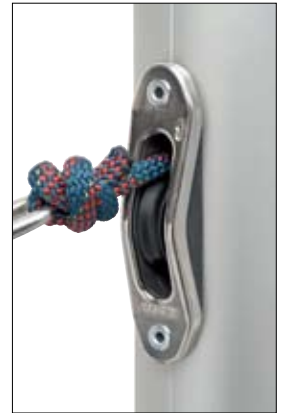
Boîte à réa à encastrer pour drisse avec protection anti-ragage
