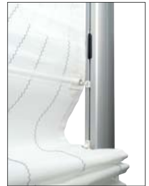
3) Les coulisseaux restent en permanence dans la gorge de mât, facilitant ainsi le hissage et la prise de ris.
