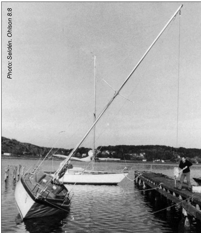
Test de gîte en 1971. Le couple de redressement du navire se mesure à 30° de gîte.
