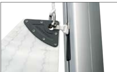
1) Insérez tous les coulisseaux dans la fenêtre d'engoujure.
