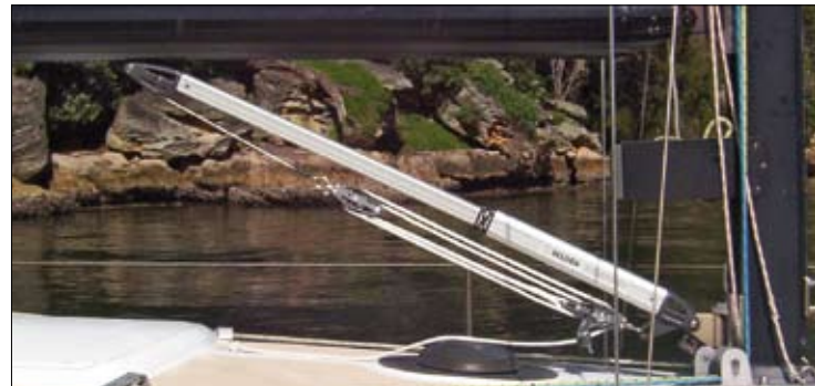
Rodkicker 05 manœuvré en pied de mât
