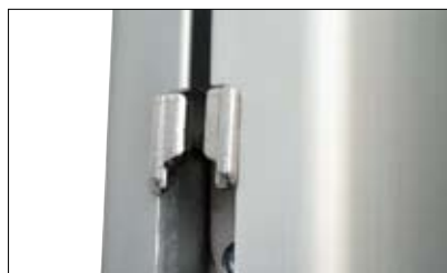
2) Insérez la ralingue dans la fenêtre d'engoujure.
