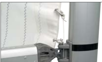
1) Fixez l'endrailleuse à la ferrure de bôme.
