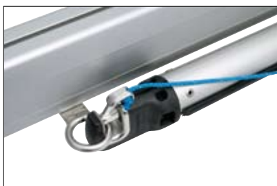
Ferrure avant à fixer au rail d'extrémité inférieur...
