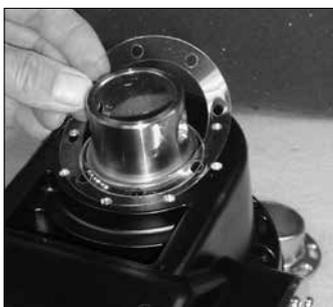
8. Coloque la arandela de aislamiento en su lugar y ajuste el aro de las chavetas. Quite y vuelva a colocar los 8 tornillos uno a uno, aplique sellador de roscas en los tornillos (suministrado en el kit) apretándolos fuertemente.
