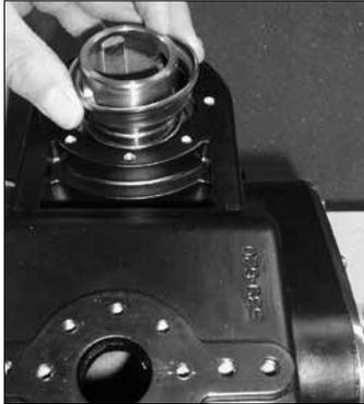
6. Quand le mécanisme inférieur est en place, retournez l'ensemble tête en bas. Montez le chemin de roulement en premier. Appliquez un peu de graisse pour roulements (fournie), puis montez la cage du roulement avec les billes fournies dans la graisse. Vérifiez que toutes les billes sont en place. (Toute bille égarée peut être remplacée par une bille de l'ancien roulement).
