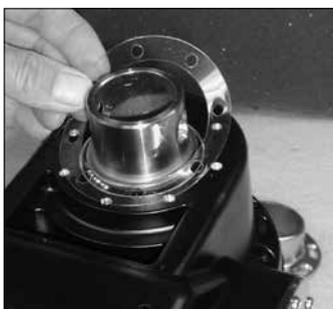
8. Posez la rondelle d'isolation et remontez la collerette. Dévissez et revissez les 8 vis une à une, appliquez un peu de frein de filet (fourni dans le kit) et serrez les vis fermement.
