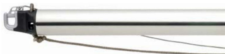
Terminal mediano de composite con protector de acero inoxidable, zafador y pata de gallo de Dyneema para la contra.
