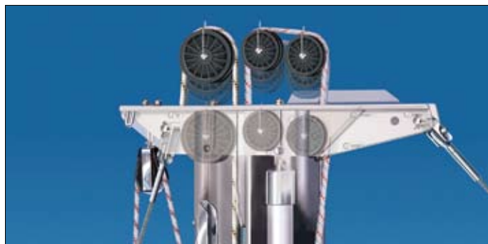
El tope de palo cuenta con numerosos elementos. Todas las roldanas y ejes se pueden cambiar sin desmontar el estay ni el backstay.
