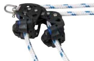
Polea en tándem para cabo del enrollador (opción) PBB50 Ref. n.º 405-001-40R (cabo Ø 10 mm máx.) PBB60 Ref. n.º 406-001-40R (cabo Ø 12 mm máx.)
