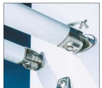
La base ancha de las crucetas en V es otra manera de incrementar la resistencia en aparejos grandes. Este anclaje de cruceta atraviesa el mástil.
