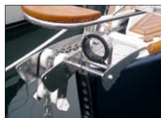
Los herrajes de proa en algunos barcos se pueden integrar en el herraje de fondeo.
