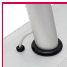
Los cables de las luces de navegación pasan por el travesaño...
