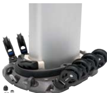
Apoye el mástil y vuelva a colocar la cuña.
