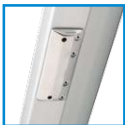
La carga del estay es absorbida por un soporte de acero inoxidable que existe debajo del travesaño.
