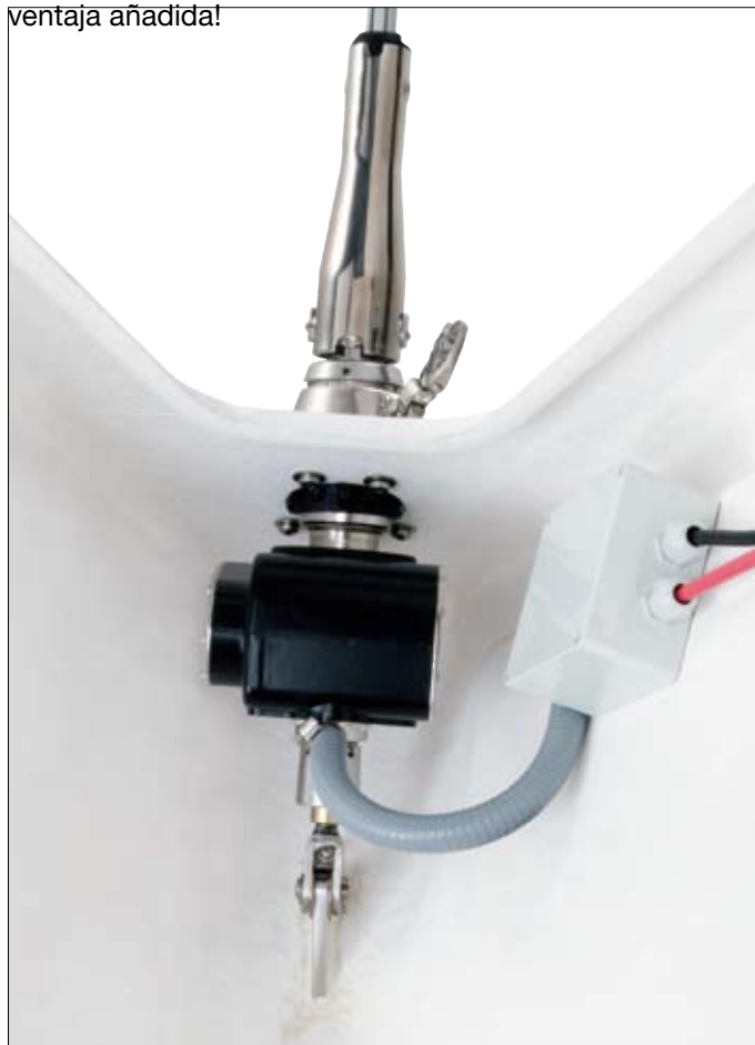
Instalación de un Furlex 200TDE La caja de conexiones es estanca.
