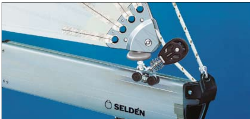
Botavara provista de carro de pajarín para mástil enrollable Seldén. Ver pajarines hidráulicos en la página 103.
