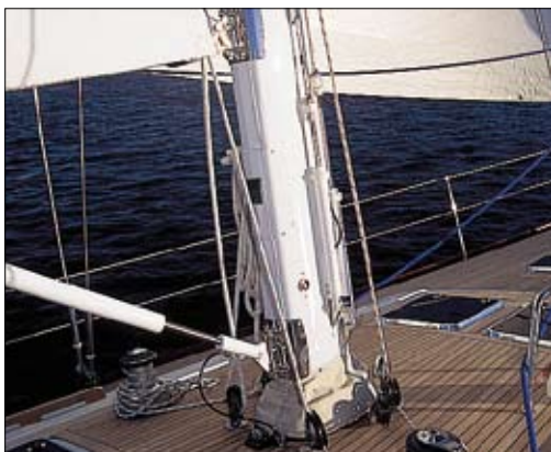
Hidráulica Seldén incorporada. Todos los componentes hidráulicos se encuentran en el interior del mástil.
