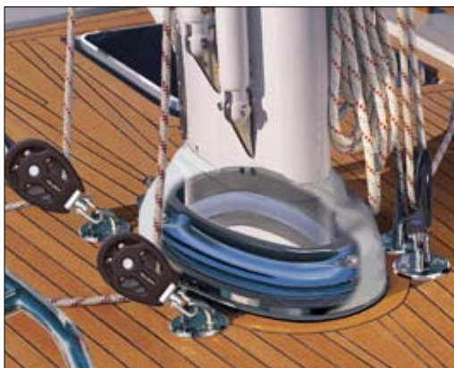
La fognadura está sellada mediante una robusta junta tórica prensada verticalmente entre dos aros. El aro inferior se atornilla de forma permanente a la cubierta y resulta fácil de instalar. Una vez instalado, deja al mástil suficiente margen para poder moverlo en todas las direcciones.
