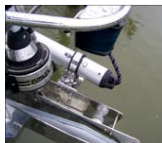
Instalación lateral en herraje de fondeo montado en la roda.
