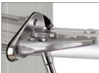
Secciones-C y secciones-F. Obenque bajo sujeto al soporte de cruceta.
