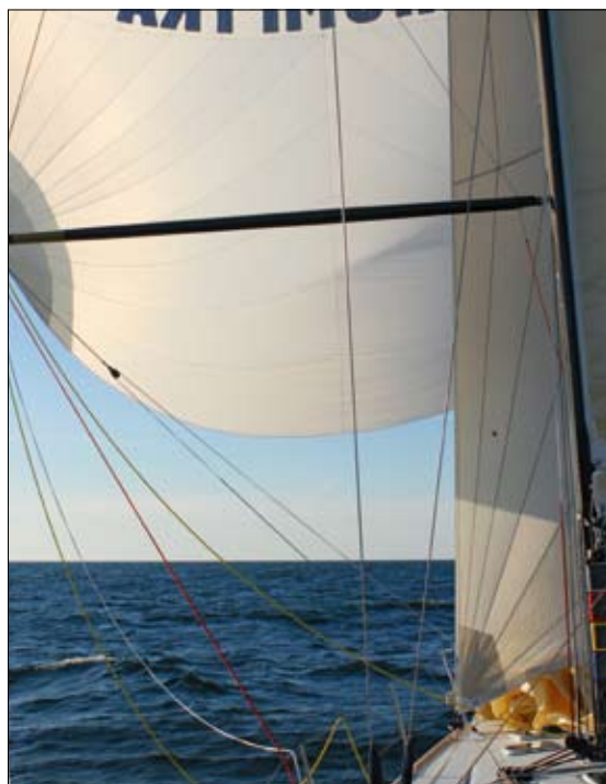
Spinnaker y vela de estay. La vela de estay se maneja con un enrollador Seldén Código X y se amura a barlovento para que la superficie vélica proyectada sea mayor.
