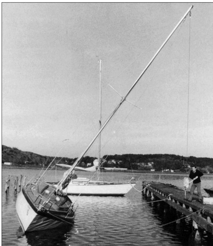
Prueba de escora en 1965. El par de adrizamiento del barco se mide a 30° de escora.
