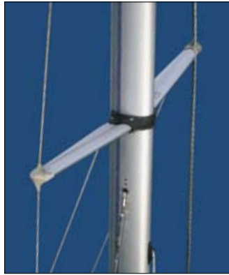
Crucetas P Seldén para Secciones-D, Secciones-E y Secciones-R.
