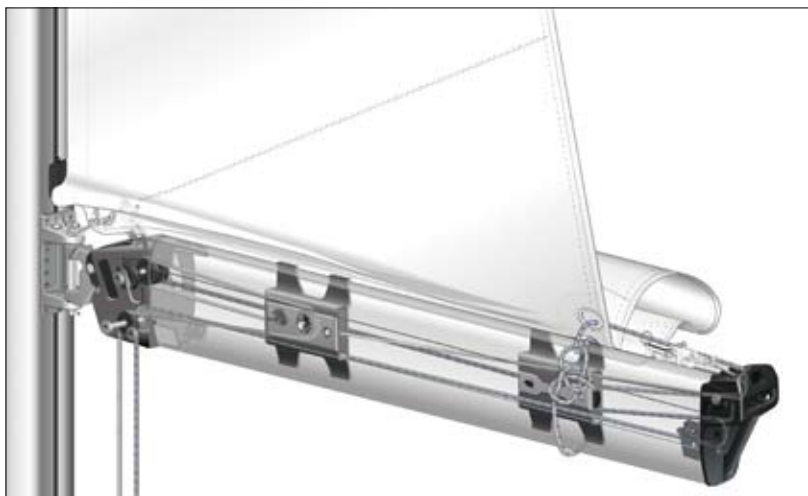
Sistema de rizo único. La baluma y el grátil bajan al mismo tiempo. La maniobra se realiza de forma segura desde la bañera.
