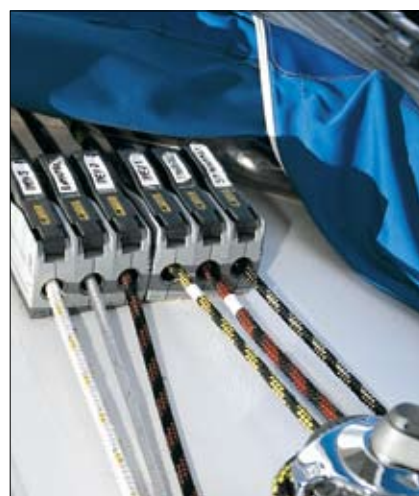
Soltar la driza de la mayor hasta las marcas de rizados previamente efectuadas.
