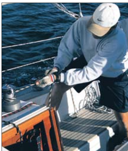
Cazar del cabo de rizo hasta la posición marcada en el propio cabo.
