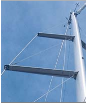
Crucetas T Seldén para Secciones-C y secciones-F.
