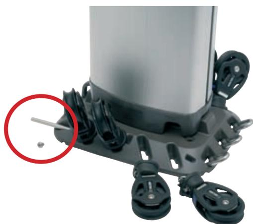
*Base en T pour mât implanté sur le pont avec système de fixation des poulies de renvoi. Il suffit d'enlever l'axe en acier inox pour installer jusqu'à huit poulies. Un axe en deux parties est disponible en cas de manque de débattement sur le pont.*
