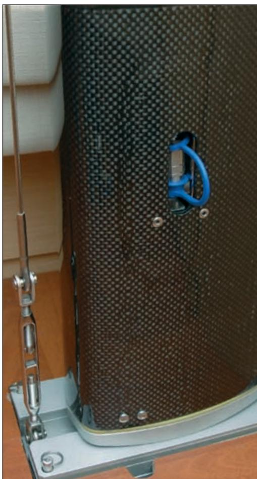
*...et peut être raccordé facilement à la pompe pour ajuster la tension du gréement.*
