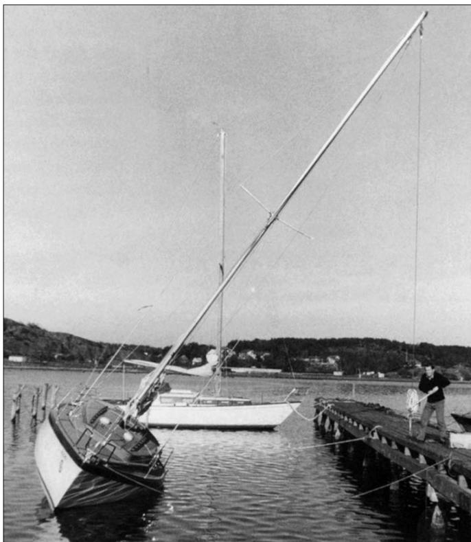
Test de stabilité en 1965. Le moment de redressement du bateau est mesuré à 30° de gîte.
