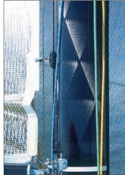
Seldén a développé un processus d'enroulement filamentaire permettant de produire des espars de très haute qualité.
