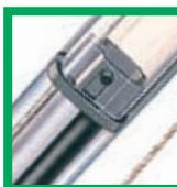
L'embout de l'extrusion interne agit comme une bague anti-friction et empêche le contact métal sur métal. Le coussinet supérieur coulissant agit comme un amortisseur élastique pour absorber les chocs au cas où le hâle-bas s'abaisserait brusquement.
