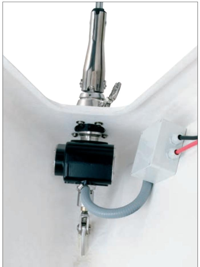
Installation d'un Furlex 200E. Le boîtier de connexion est étanche.
