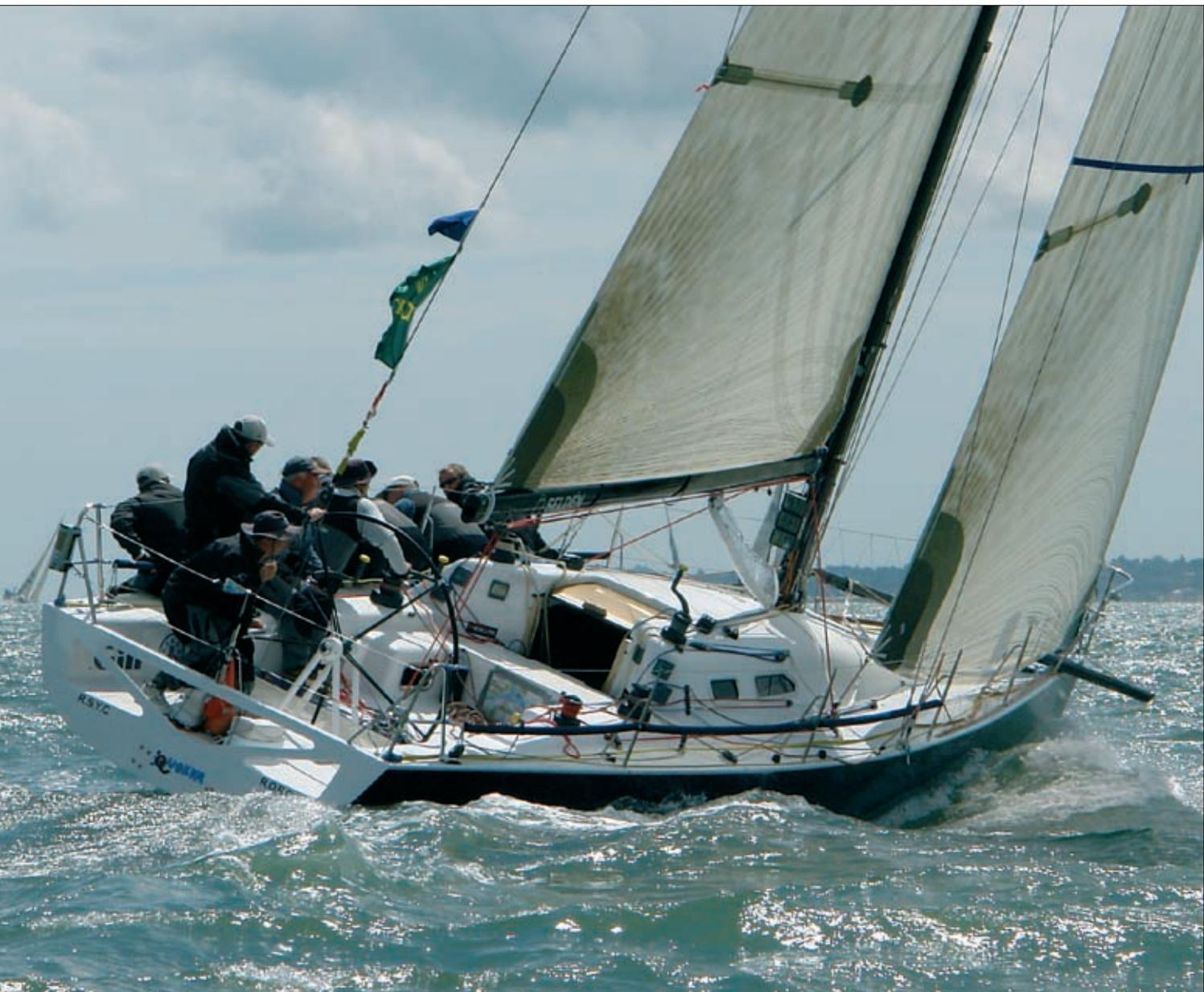
Pour une parfaite harmonie de la gamme carbone, Seldén utilise la même technologie avancée pour le développement de ses profils de bôme et de mât. Avec une bôme carbone, l'économie de poids peut atteindre 35% par rapport aux profils comparables en aluminium. Sur un voilier standard de 35' le poids moyen de la bôme atteint à peine 20 kg au lieu de 30 kg.
