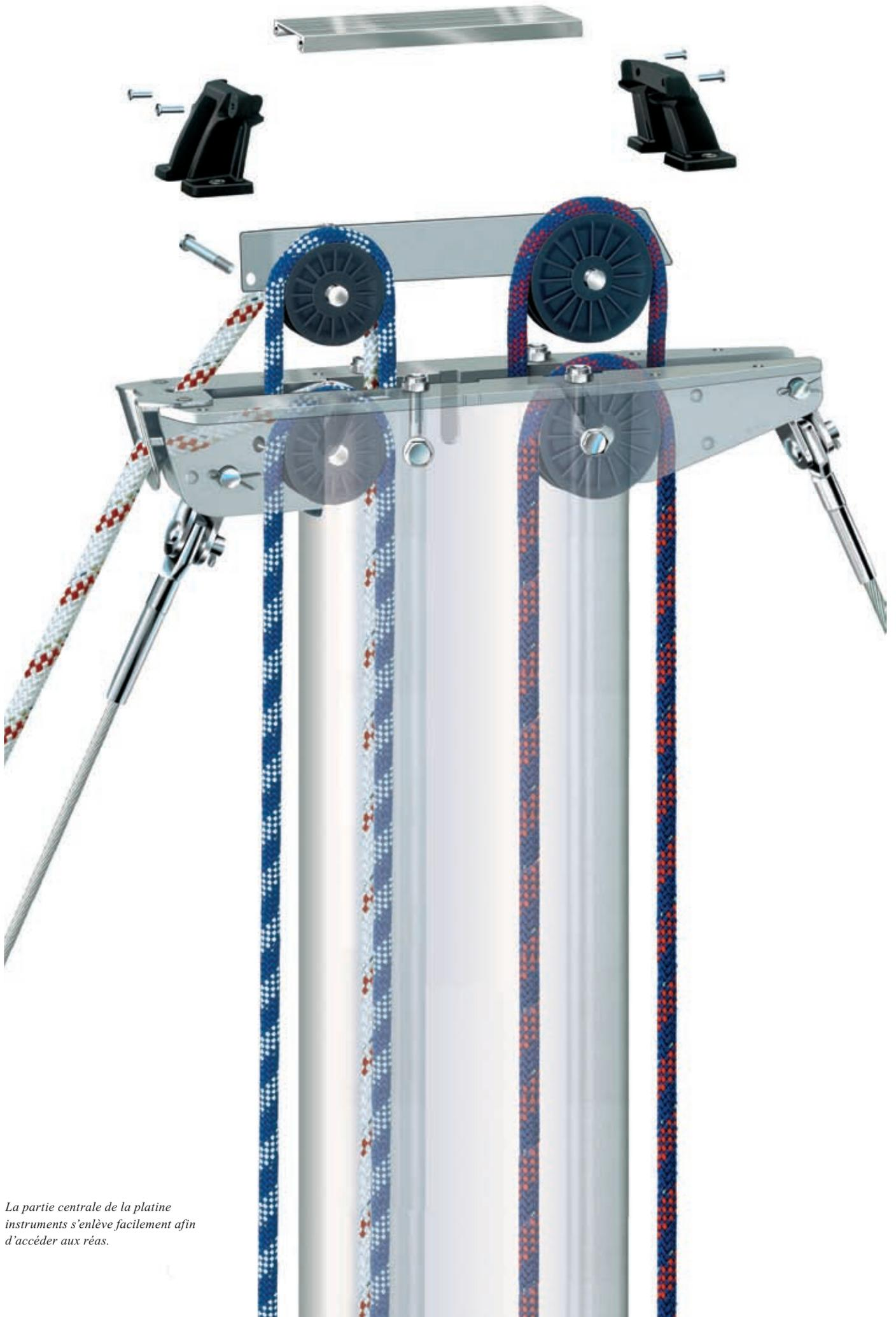
*La partie centrale de la platine instruments s'enlève facilement afin d'accéder aux réas.*
