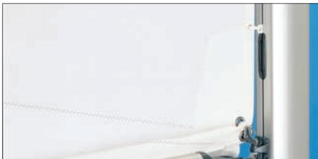
Les coulisseaux sont introduits par un clapet à ressort. Lors d'une prise de ris, les coulisseaux glissent dans la fenêtre fermée jusqu'à la bôme, maintenant la voile en place et permettant une prise de ris rapide et sûre. En cas d'utilisation d'une voile à ralingue, il suffit d'enlever le clapet à ressort de la fenêtre d'engoujure.
