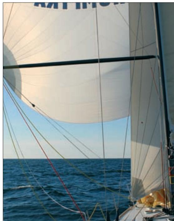
Spinnaker et trinquette. La trinquette est installée sur un emmagasineur Code X et fixée au vent pour une meilleure projection de la voile.
