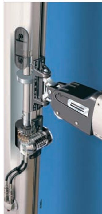
*Långedrag 501 équipé d'un mât hydraulique Seldén, de l'étarquage hydraulique et de deux enrouleurs de génois hydrauliques Furlex.*
