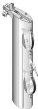
La boîte à réa arrière est fixée au dessus de la boîte à réa avant de façon à éviter le ragage de la drisse.
