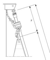
\* Weil der Rodkopf bei diesem Durchmesser zu gross ist und nicht durch die Profile geschoben werden kann, wird er erst nach Montage der gesamten Profile auf dem Rod gepresst. Die Gesamtlänge der Profile muss in diesem Fall um 200 mm gekürzt werden, weil sonst die Rodpressung nicht erfolgen kann. Die mögliche max. Vorliekslänge wird entsprechend kürzer. Die Montage der Vorstagprofile auf dem Rod muss in diesem Fall am Standort
