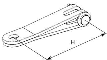
Entretoise: utilisée pour augmenter la distance entre le mécanisme inférieur et le pont, pour le passage de l'ancre par exemple.
