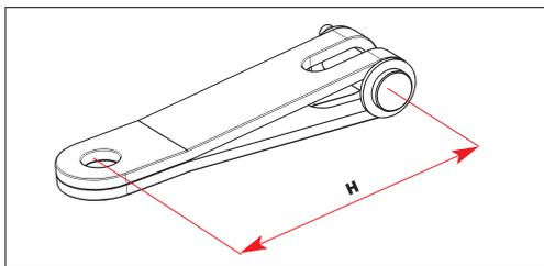
Prolongador: Articulación que eleva el giratorio inferior sobre la cubierta permitiendo el paso del ancla y que facilita las maniobras en proa.
