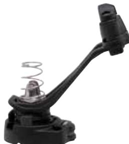
El **giratorio de mástil** guía el cabo con plena articulación hasta el trimmer. El giratorio está hecho de composite 50/50 fibra de vidrio/poliamida. Es utilizado principalmente para Cunningham, Spinnaker, Gnav, etc. La roldana tiene dos puede trabajar de dos formas diferentes, dependiendo si el cabo le llega desde arriba o desde abajo. El giratorio puede colocarse boca arriba o boca abajo dependiendo de la orientación deseada de la mordaza. La roldana es con rodamientos de bolas.
