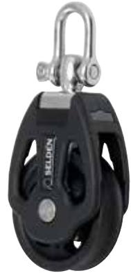
Las **poleas con rodamientos de bolas** son utilizadas cuando las cargas son más moderadas y dinámicas. Los rodamientos de acero proporcionan una rotación óptima de la roldana con el mínimo rozamiento posible. Disponibles en roldanas de 20, 30, 40 y 60 mm. de diámetro.
