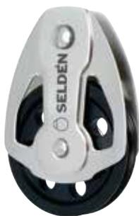
**Poleas sin rodamientos de alta carga** diseñadas para aplicaciones en la jarcia firme, como backstays y burdas. La polea está hecha en forma de V y optimizada para cables o cabos 100% HMPE. Las caras de la polea han sido finamente electropulidas siendo de acero inoxidable. Disponibles en roldanas de diámetros 45, 60, 80, 100 y 130 mm.
