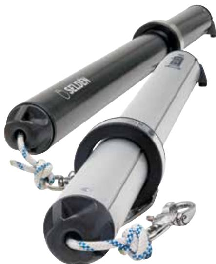
Le bout-dehors rétractable Seldén permet une navigation sous spi asymétrique plus facile, plus efficace et plus amusante. Il suffit de sortir le bout-dehors jusqu'à sa position de travail. Lorsque le spi asymétrique est affalé, il suffit de rentrer le bout-dehors et de l'assurer sur la cadène arrière. L'extrémité intérieure du bout-dehors est équipée d'une gâchette sur ressort assurant la fixation sur les cadènes. Vous avez le choix entre les modèles aluminium ou carbone.
