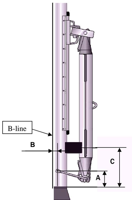
1. Markieren Sie die Bohrlöcher für den Spibügel (Maß B entsprechend nebenstehender Tabelle).
