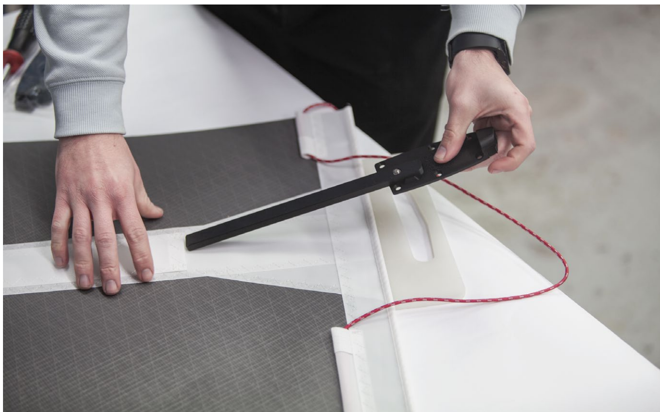
Gabarit 3D pour fixation des boîtiers de latte
