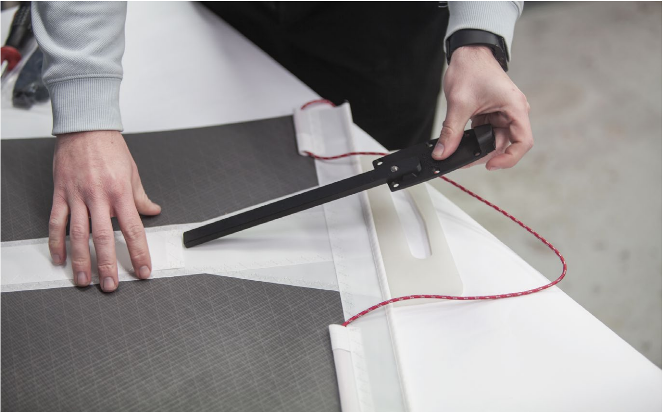
Gabarit 3D pour fixation des boîtiers de latte
