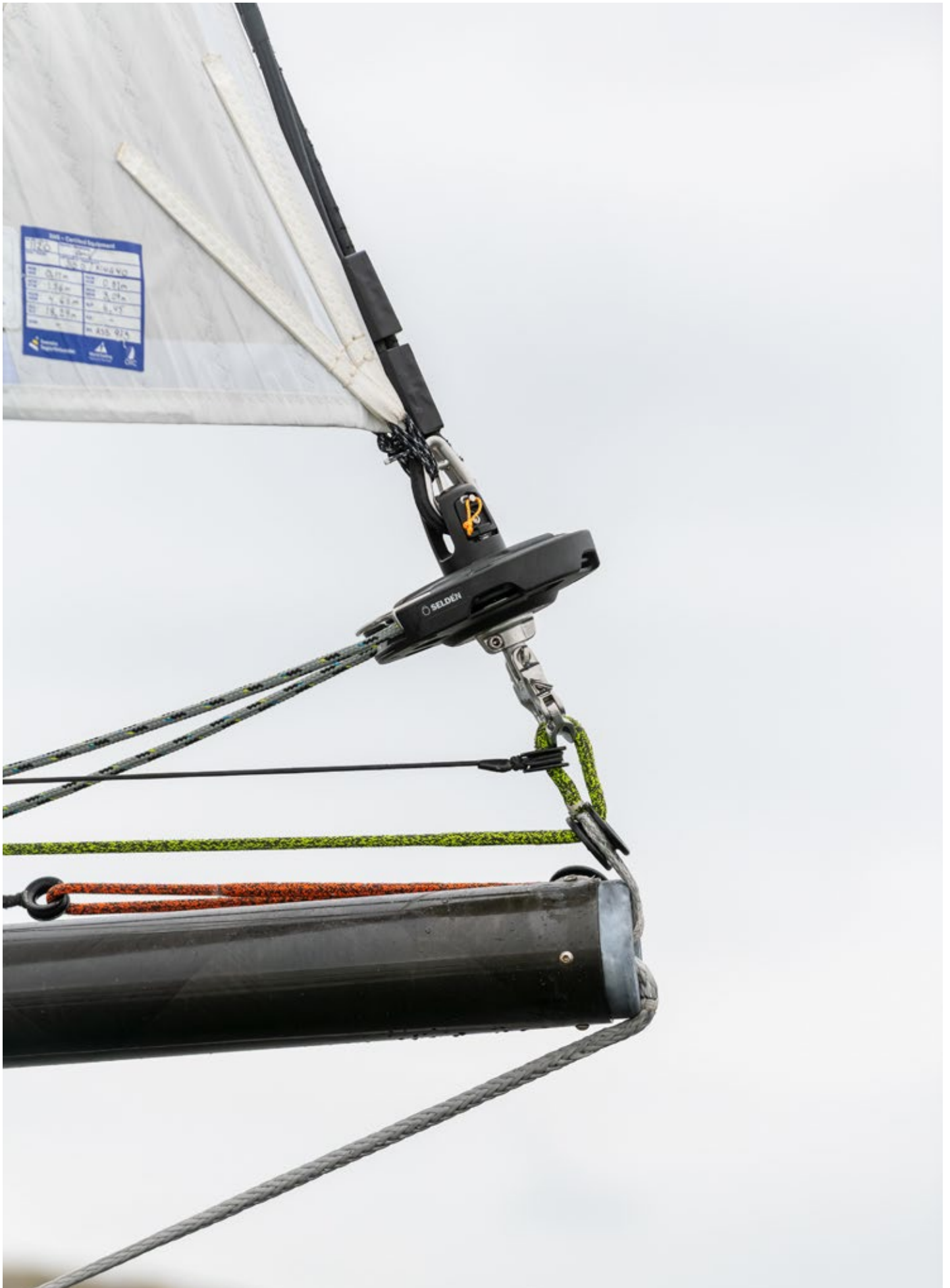
CXr på ett utskjutbart bogspröt. Lågfriktionsschackeln (tillval) under trumman är kopplad till "tack-line". Detta ger fördäcksgasten en möjlighet att koppla trumman och därefter flytta ut den på bogsprötet genom att dra i linan. Utväxlingen ger dessutom möjlighet till en hög förliksspänning.
