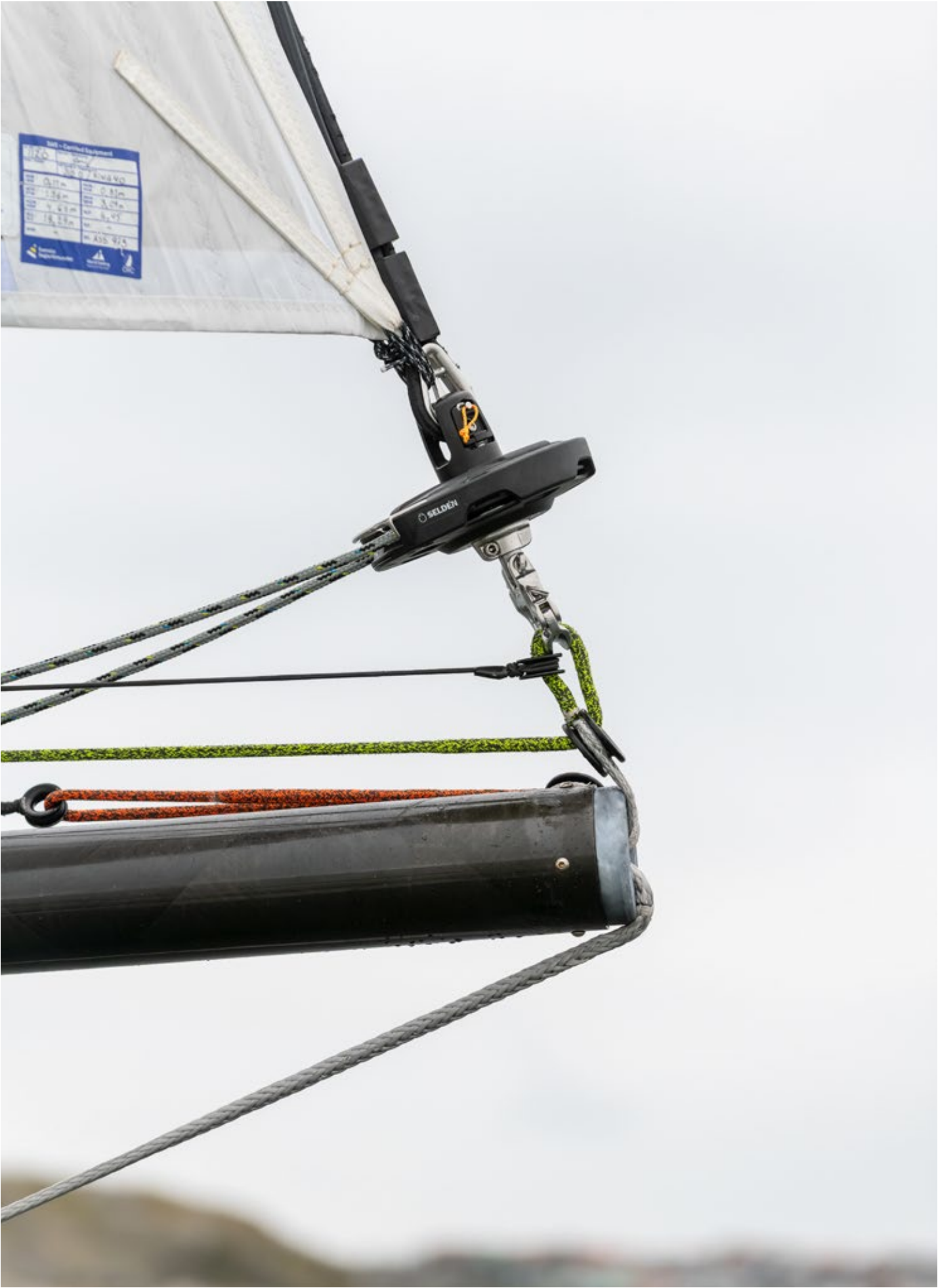
Enrouleur CXr monté sur un bout-dehors rétractable en carbone. La manille à faible friction (optionnelle), située sous le tambour, est reliée à la bosse d’amure. Le palan 2:1 permet à l’équipier d’avant de faire coulisser le tambour sur le bout-dehors tout en restant sur le pont avant, et assure également une forte tension de guindant.
