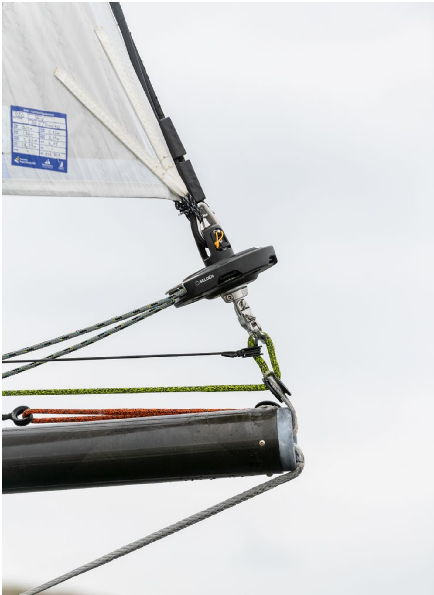
Almacenador SELDÉN CXr en un botolón de carbono SEIDÉN. El mosquetón de baja fricción (opcional) en la parte inferior del giratorio de amura se conecta al tack. La desmultiplicación 2:1 le permite al proa llevar el giratorio hasta el extremo del botalon sin salirse de la proa. Permite una alta carga en el grátil.
