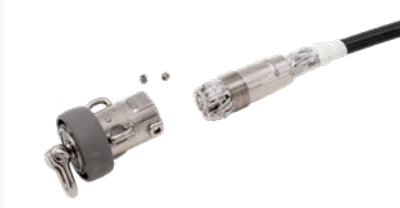
Meta el cabo por dentro del terminal y doble el alma sobre las cuñas. Meta las cuñas en el terminal.
