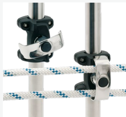
Polea violín con doble mordaza para cabo sinfín. PBB50 Ref N° 405-001-40R (diámetro máximo de cabo 10 mm.) PBB60 Ref N° 406-001-40R (diámetro máximo de cabo 12 mm.)
