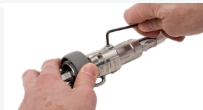
Montera lintrumman/fallsvirveln och drag åt låsskruvarna.
