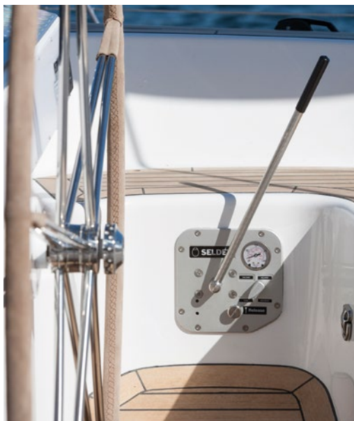
Kontrollpanel, 4 funktioner med pumphandtag
