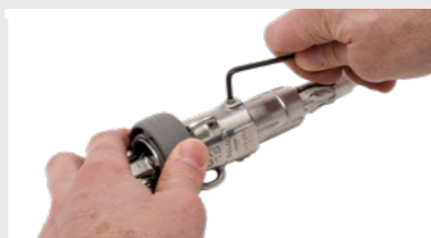
Montera lintrumman/fallsvirveln och drag åt låsskruvarna.
