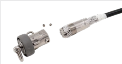
Trä på terminalen på linan och vik linans kärna över den tredelade konan. Fixera konan i terminalen.
