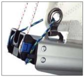
Embout arrière Les cordages peuvent être bloqués par deux taquets latéraux ou par un bloqueur en V sous le réa tribord.
