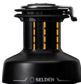
Nos nouveaux winchs manuels et électriques sont équipés de poupées en aluminium anodisé dur forgé, usinées avec des nervures verticales asymétriques. Chaque section de cordage sous charge repose sur des rainures verticales, qui grâce à leurs positions asymétriques, garantissent un grip solide et un choqué harmonieux.
