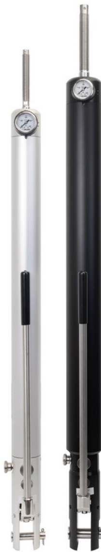
Hydrauliska akterstagssträckare med integrerad pump (HTI)
