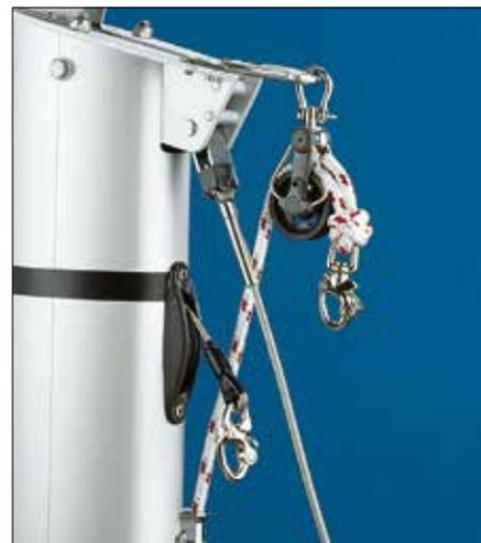
Gréement en tête ou fractionné. Seldén offre une gamme complète de fixations simples et doubles de drisse de spinnaker.
