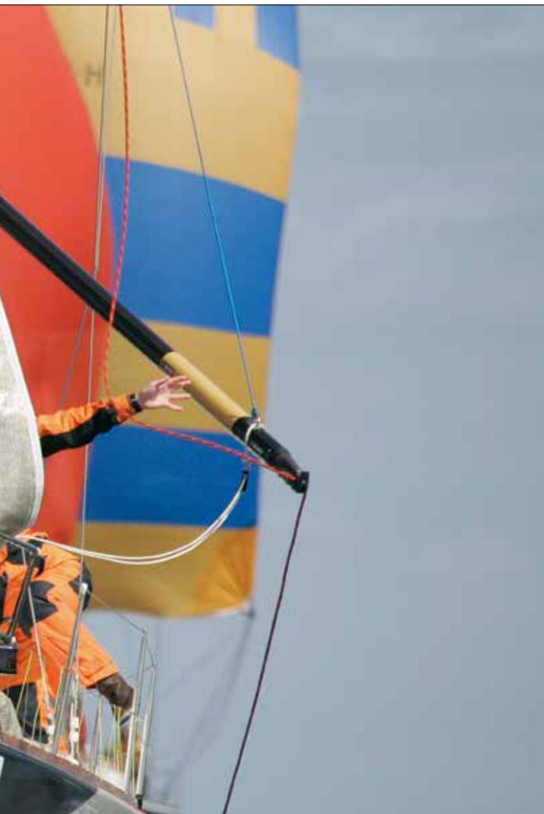
Les tangons de spinnaker Seldén sont conçus pour alléger les manœuvres de spinnaker. Le gros avantage de la fibre de carbone est son poids très faible. L'économie de poids permet à l'équipage de manœuvrer le spinnaker plus rapidement et avec moins d'efforts.
