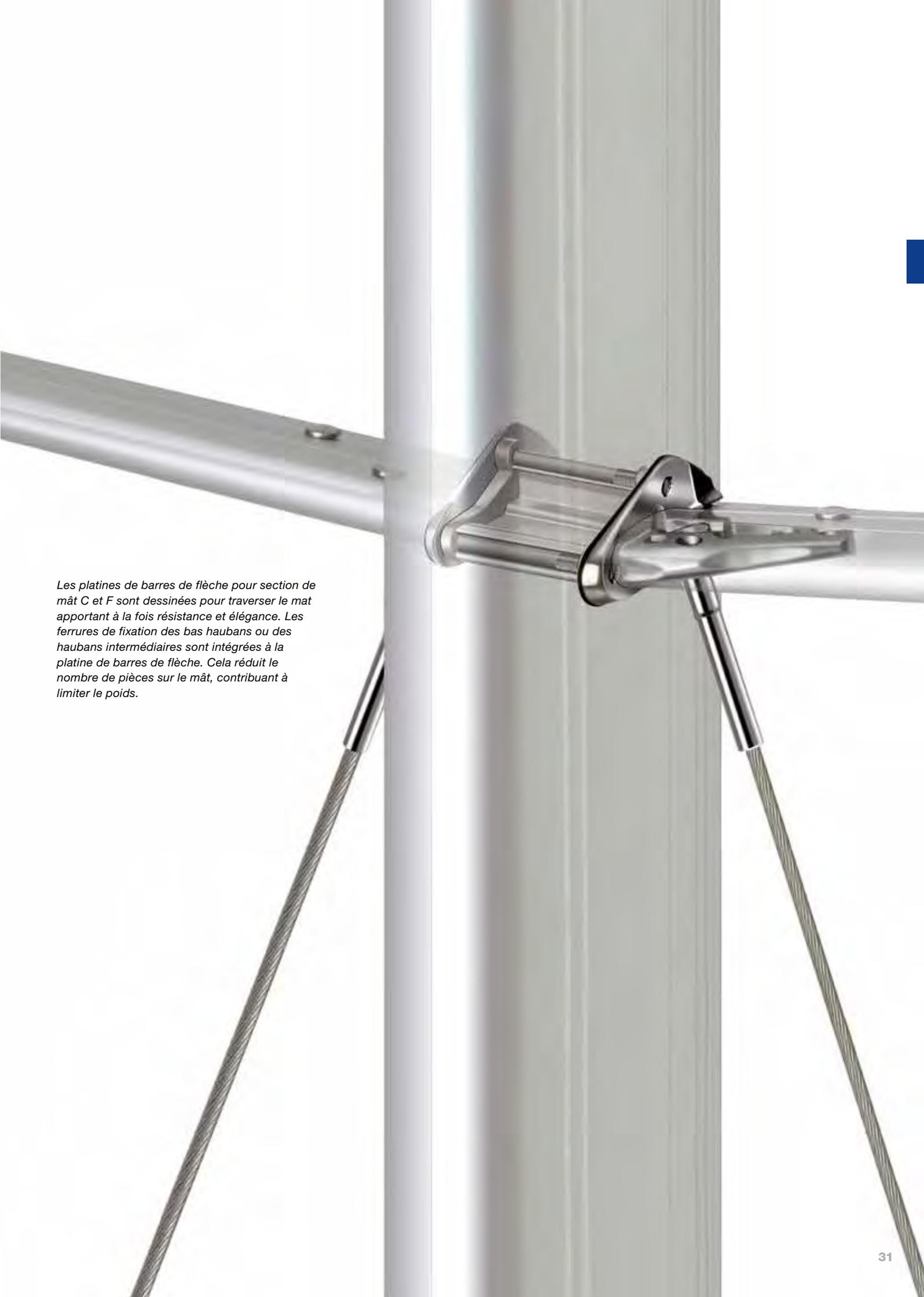
*Les platines de barres de flèche pour section de mât C et F sont dessinées pour traverser le mât apportant à la fois résistance et élégance. Les ferrures de fixation des bas haubans ou des haubans intermédiaires sont intégrées à la platine de barres de flèche. Cela réduit le nombre de pièces sur le mât, contribuant à limiter le poids.*
