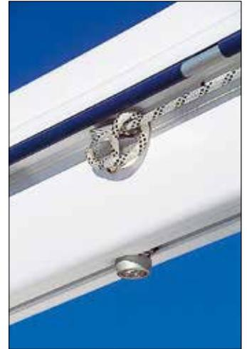
**Eclairage intégré aux barres de flèche en V**
