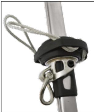
L'émerillon de drisse pour Furlex 104S et 404S dispose de roulements à billes en acier inoxydable. La charge est centrée par l'utilisation des lashings en Dyneema®.
