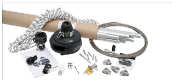
Comme sur les précédents modèles de Furlex, la configuration standard nécessite que l'étai soit coupé à la bonne longueur et fixé avec le système de terminaison « sta-lok ». Une option ridoir-intégré est proposée. Cela permet un débattement de 80 mm de réglage de longueur d'étai sans modifier la hauteur du point d'amure.
