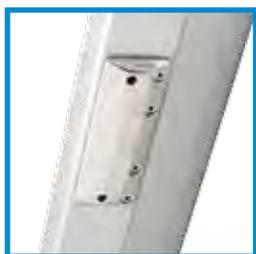
La tension d'étai est absorbée par un support en acier inoxydable installé sur le dessous de la poutre.
