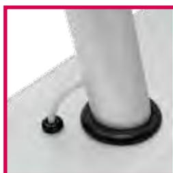
Les câbles pour les feux de navigation passent à l'intérieur de la poutre...
