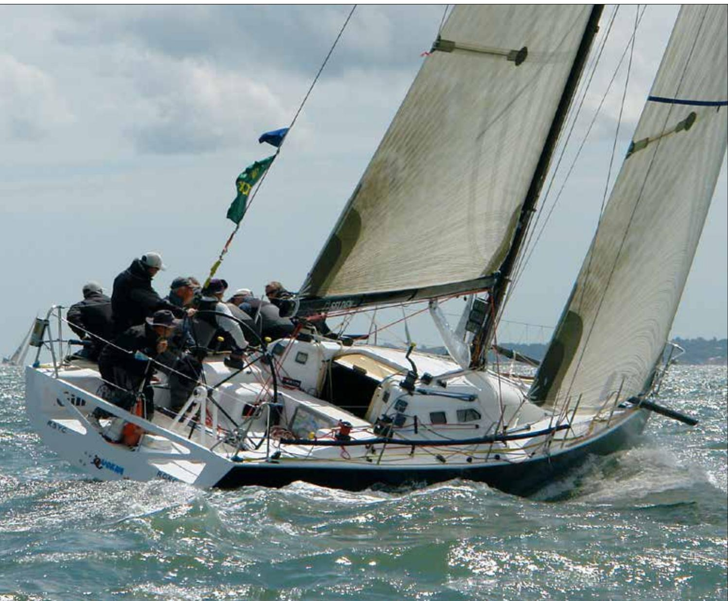
Seldén propose une gamme de bôme carbone dans la lignée de la gamme de mâts carbone. Une bôme carbone permet un gain de poids de l'ordre de 35% par rapport à une bôme aluminium. Cela signifie que sur un voilier de 35 pieds, on peut passer de 30kgs à 20 kgs de poids de bôme..
