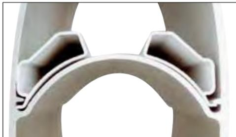
*Les mâts enrouleurs Seldén sont équipés d'un double conduit de câbles permettant aux câbles de passer librement et bien à l'écart du grément courant.*
