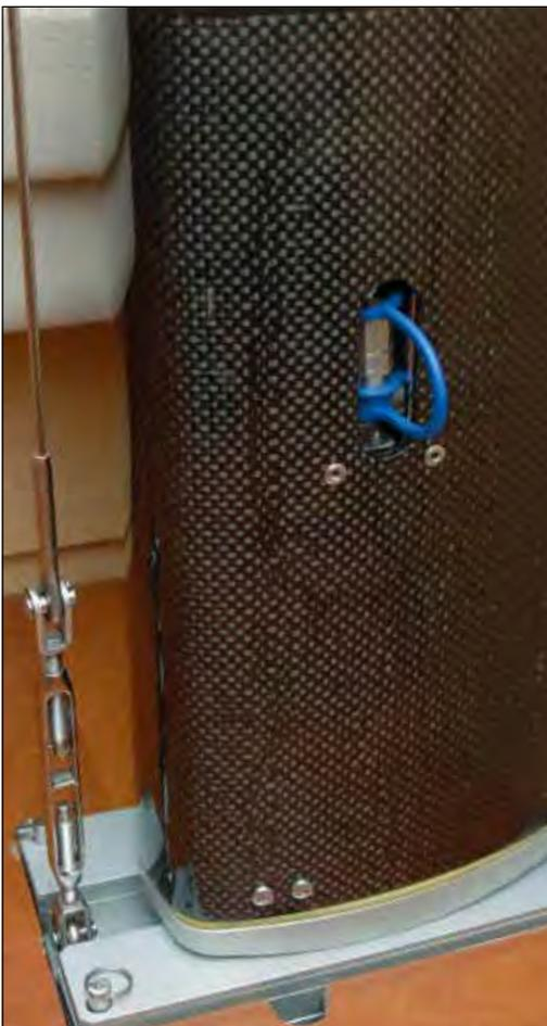
*...et peut être raccordé facilement à la pompe pour ajuster la tension du gréement.*
