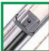
L'embout de l'extrusion interne agit comme une bague anti-friction et empêche le contact métal sur métal. Le coussinet supérieur coulissant agit comme un amortisseur élastique pour absorber les chocs au cas où le hale-bas s'abaisserait brusquement.
