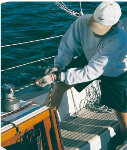
Étarquer la bosse de ris jusqu'à la marque faite sur la bosse.
