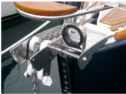
Im Ankerbeschlag integrierter Führungsring.
