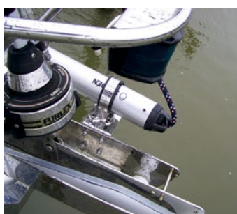
Montering på sidan av ett bogankarbeslag.
