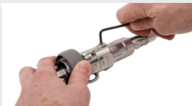
Trä på terminalen på linan och vik linans kärna över den tredelade konan. Fixera konan i terminalen.
