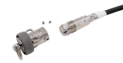
Trä på terminalen på linan och vik linans kärna över den tredelade konan. Fixera konan i terminalen.
