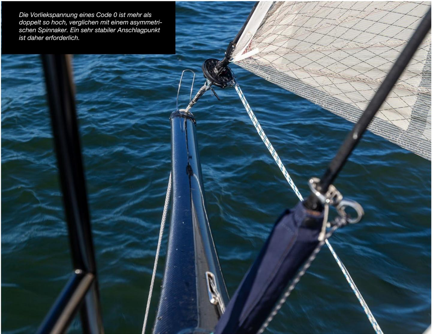
*Ein Seldén CX15 für Code 0 auf einer Race 80 Bugplattform von Båtsystem, Schweden ([www.batsystem.se](http://www.batsystem.se)).*
