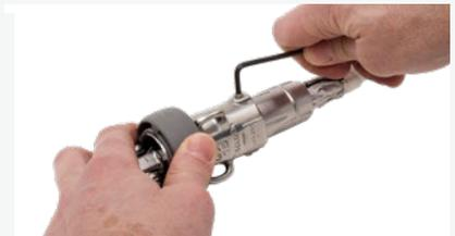
Schrauben Sie das System zusammen und ziehen die Feststellschrauben fest.
