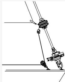
Der Trimmwirbel besteht aus 2 Teilen und kann nachträglich ohne großen Aufwand auf dem AT-Cable montiert werden.
