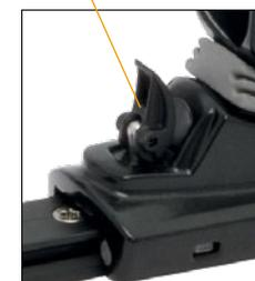
La fonction de blocage est un piston à ressort qui vient se bloquer dans le trou de réglage du rail. Le chariot est facile à rebloquer quand il n'est pas sous charge.
