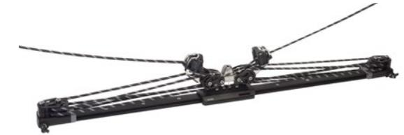
Le taquet coinqueur est orienté vers l'équipier et l'angle est réglable avec précision à l'aide de cales, 433-216-01R, voir page 87. Il peut également être ajusté horizontalement ce qui le rend particulièrement ergonomique et permet de soulager l'équipier lors de longues navigations. La chape accepte les poulies PBB 60, PBB 70 et RBB 60. Pour régler les taquets coinqueurs, se reporter à la page 66.
