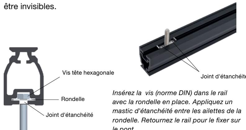
Insérez la vis (norme DIN) dans le rail avec la rondelle en place. Appliquez un mastic d'étanchéité entre les ailettes de la rondelle. Retournez le rail pour le fixer sur le pont.
