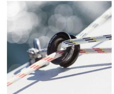
Anneau à friction utilisé à la fois pour l'écoute de spi et celle d'un code 0.
