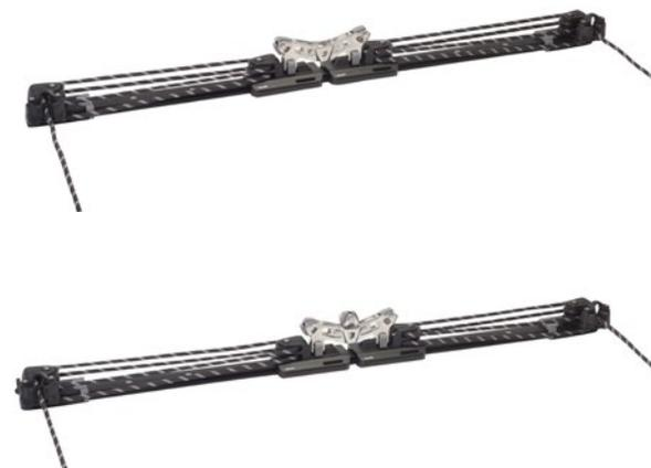
Contrôle par taquets coinçeurs fixés aux embouts de réglage. Applicable, par exemple, aux systèmes sur rouf combinés avec une écoute frappée à mi-longueur de la bôme.
