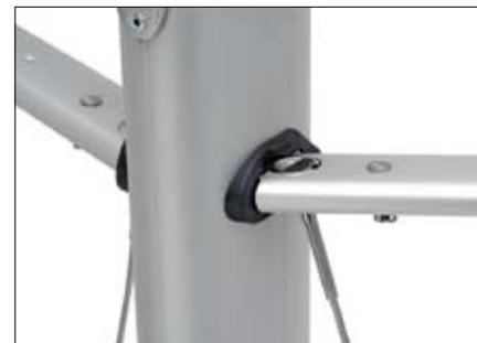
Obenques bajos fijados sobre el soporte de cruceta de barra transversal.
