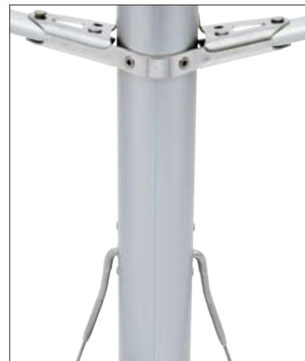
Obenques bajos fijados sobre la placa de apoyo.
