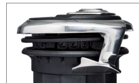
Der Selftailing-Mechanismus hat nicht die traditionelle Keilform, sondern im Innenbereich liegen die Zahnkränze annähernd parallel. Ein Federmechanismus hält die Schot zuverlässig in den Zahnkränzen. Der Führungsarm ist aus hochglanzpoliertem nichtrostendem Stahl.
