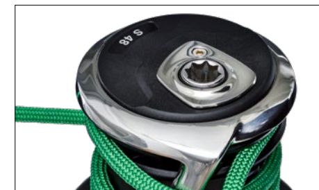
Die Trommel ist aus hart anodisiertem Aluminium hat eine konkave Form, die der Schot unter Zug sicheren und festen Halt gibt.
