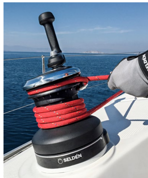
L'accroche de la poupée et un self tailing ingénieux permettent de laisser la manivelle à poste pendant que vous reprenez le mou de l'écoute.
