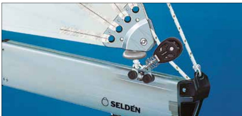
Bôme équipée de chariots de déroulement à faible friction pour mât enrouleur Seldén.
