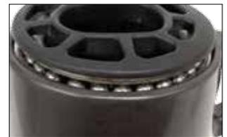
Los rodamientos de bolas y sus pistas están fabricadas en acero marino. El distribuidor de carga patentado de Seldén hace que tanto el modelo 204S y 304S ofrezcan una muy baja resistencia al enrollado y una gran durabilidad. Este concepto se introdujo en 1983 y funciona sin problemas en la actualidad.
