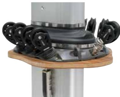
Fogonadura con junta de estanqueidad.
