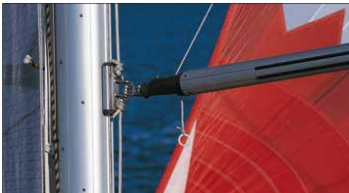
El sistema de amantillo de coz reduce el esfuerzo en la maniobra del spinnaker y permite a la tripulación llevar la vela hasta la posición perfecta.
