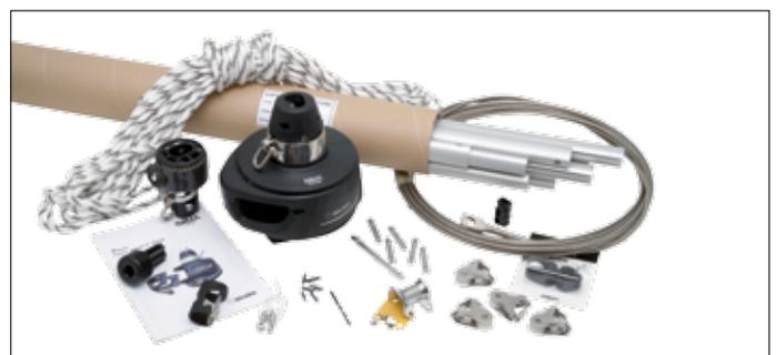
Similar a modelos anteriores Furlex, el kit estándar requiere que el cable se corte a la longitud exacta y fijado con un terminal manual 'Sta-lok'. Un tensor completamente integrado se ofrece como opción. Permite ajustes de 80 mm. en la longitud del estay sin alterar la altura del anclaje del puño de amura.
