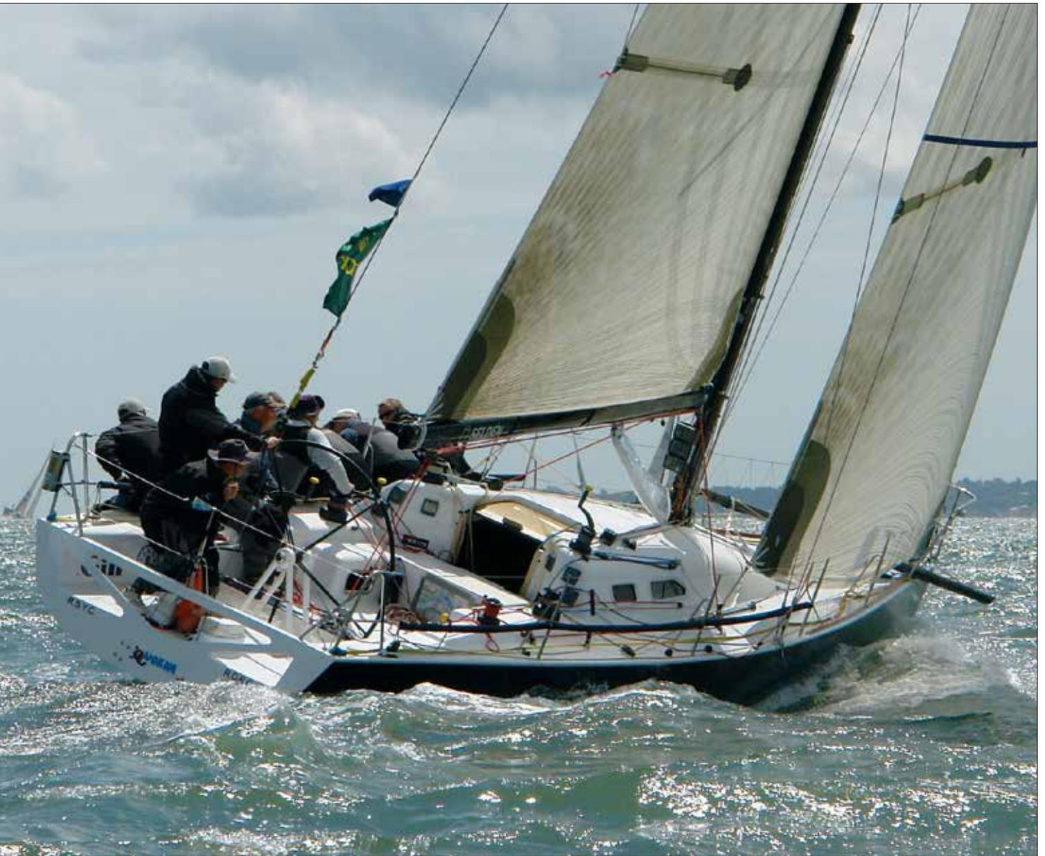
Seldén puede asimismo suministrar botavaras de carbono en consonancia con su gama de mástiles de carbono. Las botavaras de carbono permiten ahorrar hasta un 35% de peso en comparación con las de aluminio. Esto significa que el peso de la botavara en un barco de normal de 35 pies se reduce de 30 a sólo 20 kg.
