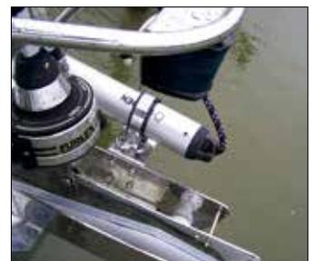
Instalación lateral en herraje de fondeo montado en la roda.
