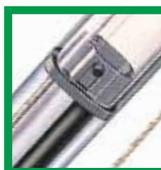
El tope del perfil interior se desliza como un casquillo en el interior e impide el contacto entre los metales. El rodamiento superior actúa también como muelle para amortiguar el golpe si la contra hiciera tope.
