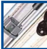
La contra Rodkicker se puede suministrar con un cilindro neumático opcional. Cuando se suelta el cabo de la contra, el cilindro neumático levanta la botavara y se abre la baluma. Una Rodkicker con cilindro neumático sustituye al amantillo y hace más fácil y rápida la toma de rizados. El cilindro neumático es de fácil instalación en cualquier Rodkicker que no disponga del mismo. Para cilindros neumáticos de repuesto, vea la página 69.
