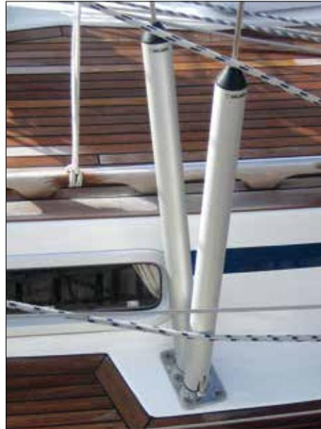
Cuando el estay de popa esté completamente tenso, márkelo con cinta adhesiva (ver fig. 1) en la parte superior del tensor. La marca de cinta le permitirá evitar el exceso de tensión. Los valores intermedios se pueden marcar con diferentes colores.
