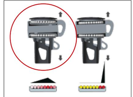
El distribuidor de cargas Seldén previene las cargas puntuales!
