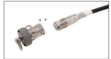
Meta el cable por dentro del terminal y doble el alma sobre las cuñas. Meta las cuñas en el terminal.
