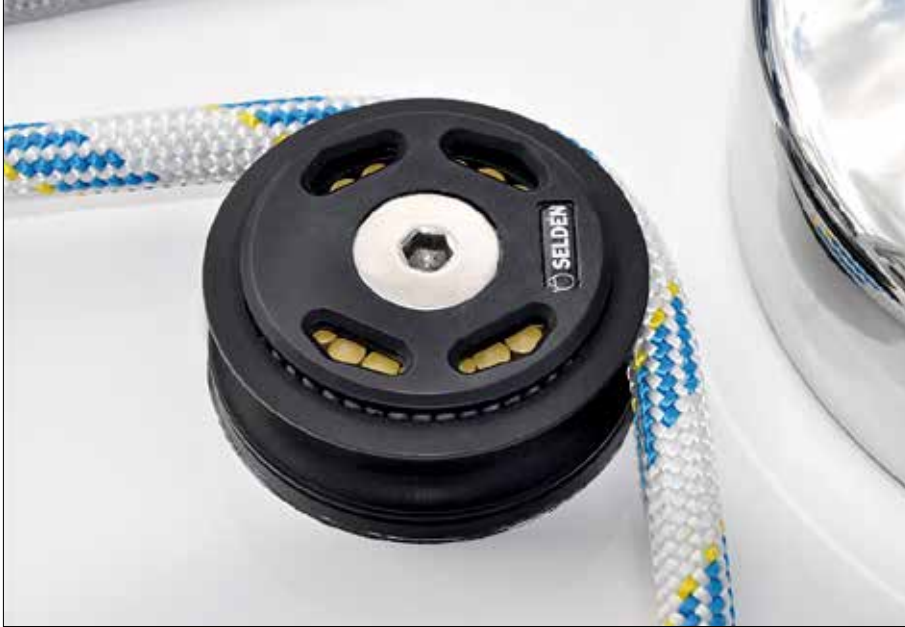
Le réa de winch permet de guider le cordage jusqu'au winch.
