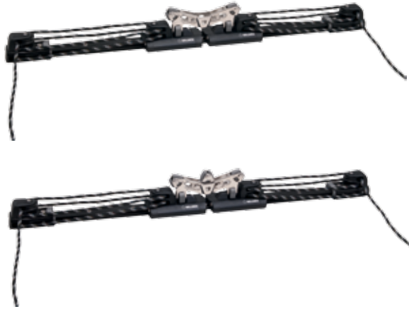
Le palan de réglage arrive dans un taquet coinreur indépendant.
