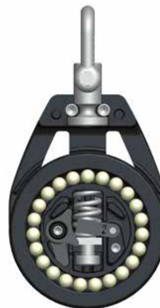
Poulie winch automatique, faible charge. Quand la poulie est sous faible charge, le cliquet est débrayé et le réa tourne librement.
