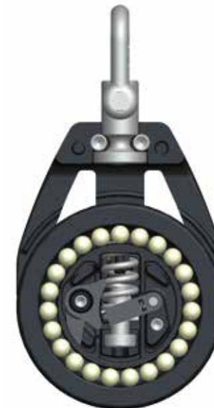
Poulie winch automatique, charge élevée. Quand la charge sur la poulie augmente, le cliquet est embrayé et le réa est verrouillé dans une seule direction.
