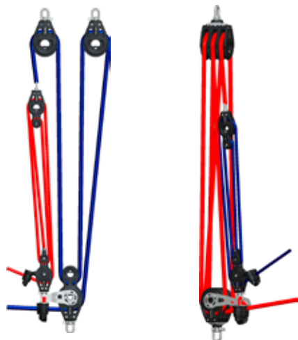
Exemple de palans à réglage fin pour écoute de GV.
