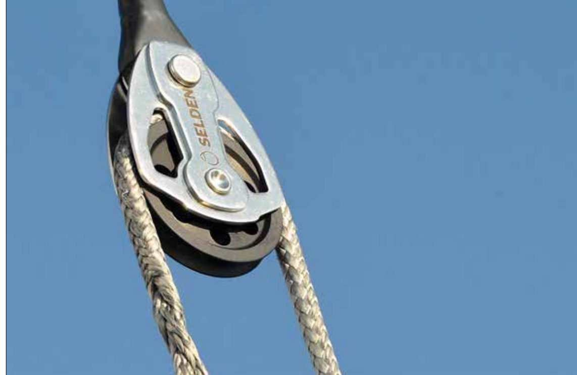
Un cordage à âme Dyneema peut remplacer du câble monotoron souple.
