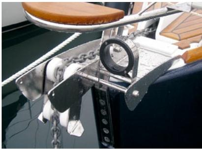
Im Ankerbeschlag integrierter Führungsring.
