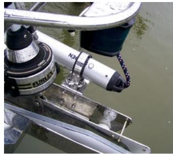
Seitlich montierter Führungsring
