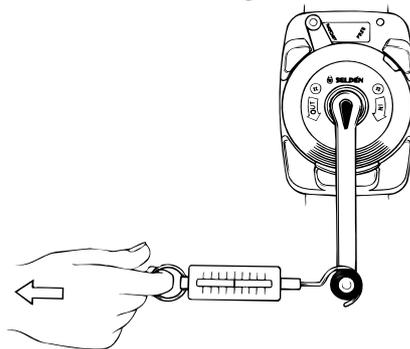
Die Einrollwisch mit der Kurbel und der Federwaage.
