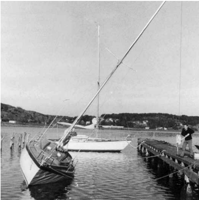
Krängungstest 1965. Das aufrichtende Moment des Bootes wird bei 30° Krängung gemessen.
