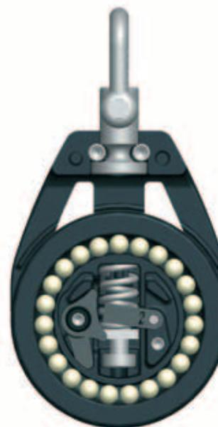
*Polea winche automática, baja carga. Cuando la polea tiene una carga baja, se desacopla el mecanismo winche y la roldana gira libremente.*
