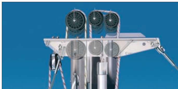
Finessen med masttoppbeslaget finner man på insidan. Alla trissor och axlar kan bytas utan att demontera för- och akterstag.
