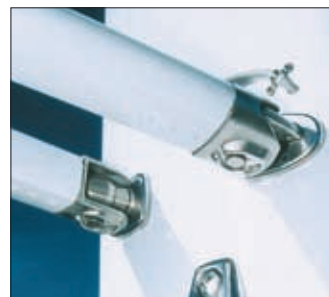
Den breda basen på V-spridaren är ytterligare ett sätt att öka hållfastheten på större riggar. Denna typ av fäste är en genomgående konstruktion.
