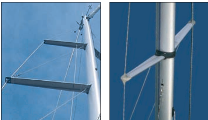
Seldén T-spridare för C- och F-profiler. Seldén P-spridare för D-, E- och R-profiler.
