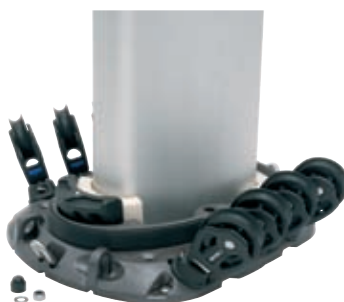
För masten genom däck och sätt tillbaka kilen.
