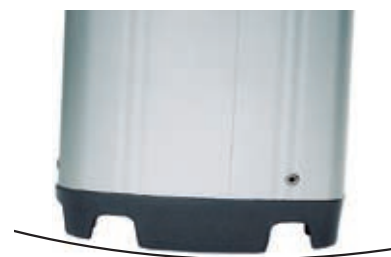
Mastskoning med konvex undersida. Fördelar kompressionslaster på mastprofilen.
