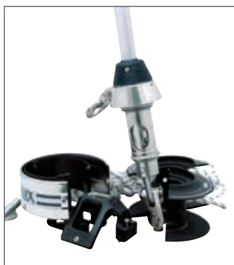
Ta bort linhållare, linledare, lina och trumhalvor.
