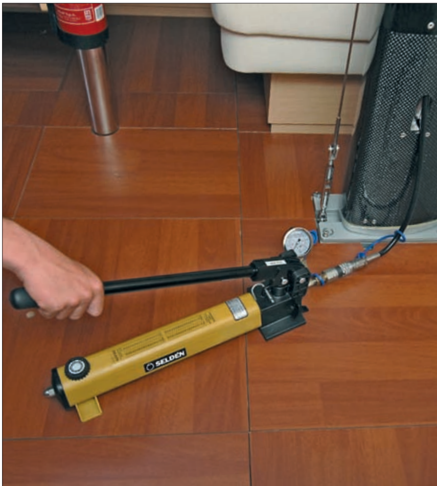
...och kopplas enkelt till pumpen för justering av riggspänningen.
