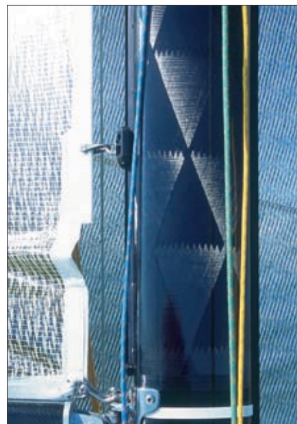
Seldén har utvecklat en unik fiberflättningsmetod för att tillverka master i kolfiber.
